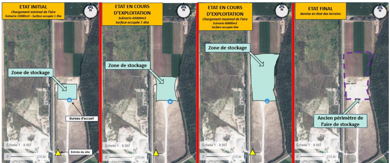
Figure 4: Phases d'exploitation et de remise en état du site de stockage selon plusieurs scénarios de volumes de bois (de 15000m 3 à 60000m 3 ) (source personnelle)
